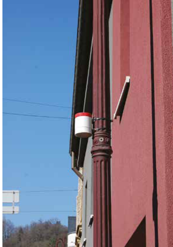
Der Passivsammler für Stickstoffdioxid (NO 2 ) am Standort „Rue de Stavelot“
